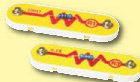
Oporniki (R1 & R2)
